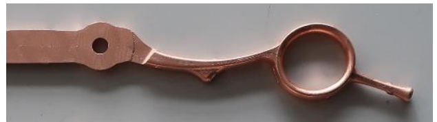
図 2 CAD で設計し、CAM で加工プログラムを作成して加工を行った（機能的で無駄のないと感じられる）サンプル
