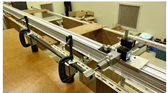
図13 長尺標準器 (CB850) による測長精度の評価
