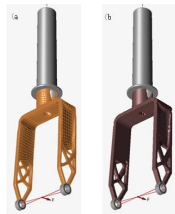
図 6 既存形状からトポロジー最適化計算を実施した計算結果 (a) 質量の最小化(安全係数 1.5)、(b) 剛性の最大化(減少率 50%)
