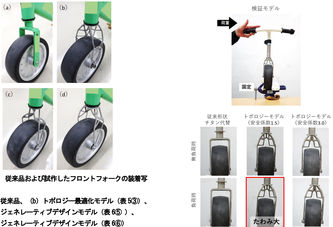
図14 横方向からの荷重荷重検証モデルおよび検証結果
