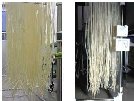
写真 1 乾燥終了後の乾麺 （左：最低湿度 55%設定、右：最低湿度 65%設定）
