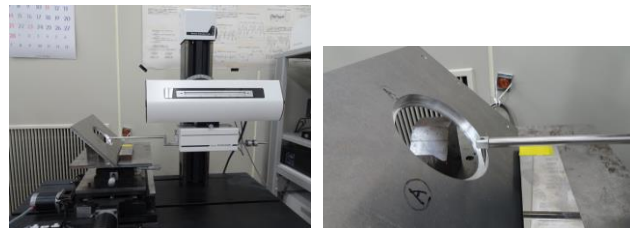
図 16 蓋マッチプレートの形状検査 (左: 全景、右: スタイラス部)
