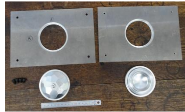
図 13 蓋マッチプレート金型の構成
