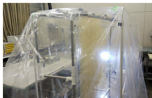
写真4 全体をシートで覆い密閉環境にした乾燥設備
