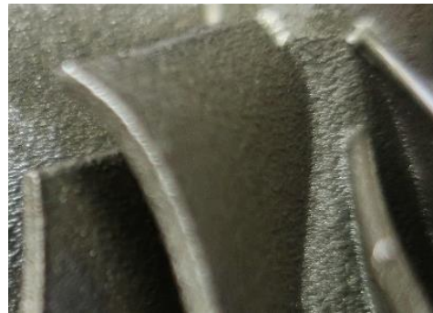
図 6 金属粉末積層造形装置で造形したインペラの表面
