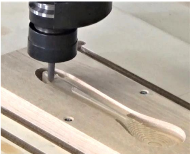
図19 NCルーターによる自動加工の様子
