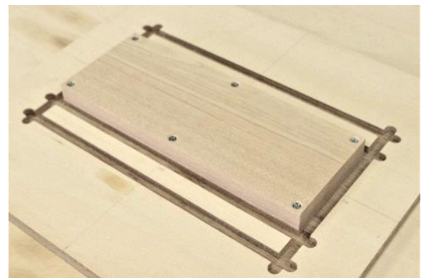
図8 被削材の固定方法
