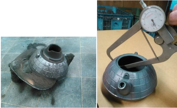
図19 型バラし後の 試作品（本体）
