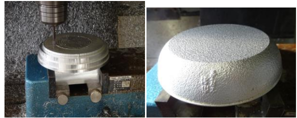
図13 原型下側の加工(左:荒、右:完了後)
