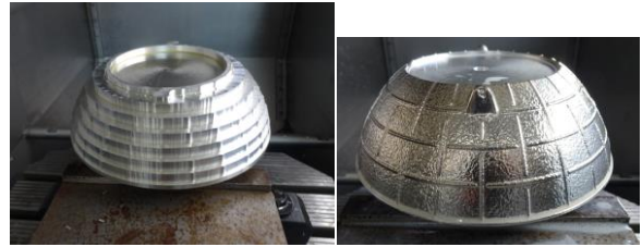
図12 原型上側の加工(左:中荒、右:完了後)
