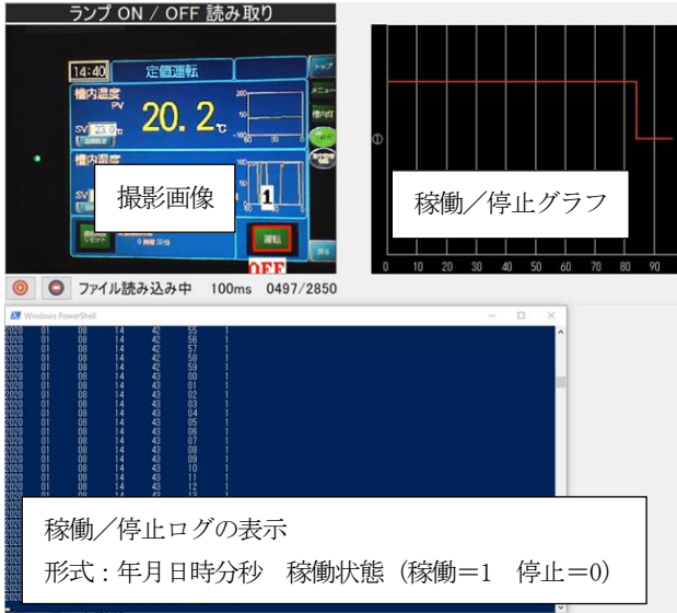
図6 実証実験における監視ソフトウェアの画面の例
