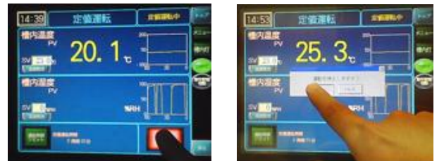
(a) 稼働/停止ボタン操作 (b) ポップアップメニュー操作 図8 稼働/停止の切り替え作業
