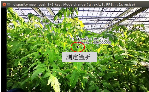
図5 カラーステレオカメラによる距離測定
