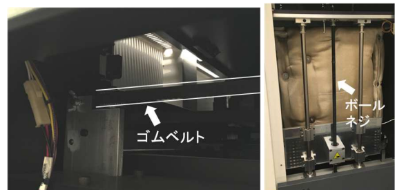
図14 FDMの駆動構造（左：Y軸、右：Z軸）
