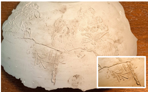
図11 光造形による押し型の文様の転写
