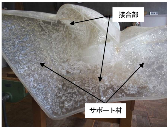
図5 底部から見た構造体内部
