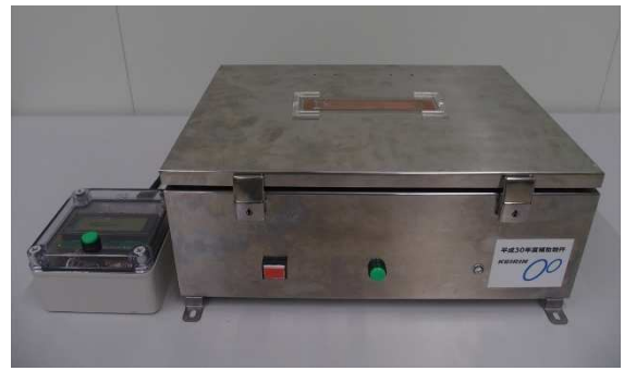
図6 試作した水分量・塩分量測定器
