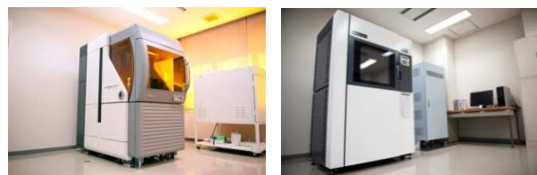
図 1 樹脂 3D プリンタ (左：光造形法、右：熱溶解積層法)
