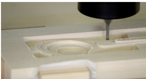
図17 表面の荒加工の様子
