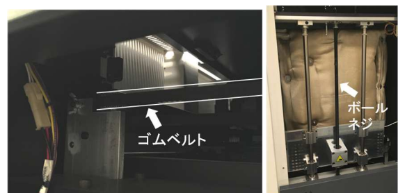
図14 FDMの駆動構造（左：Y軸、右：Z軸）
