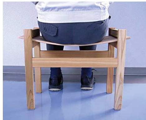
写真10 座板のしなる様子
