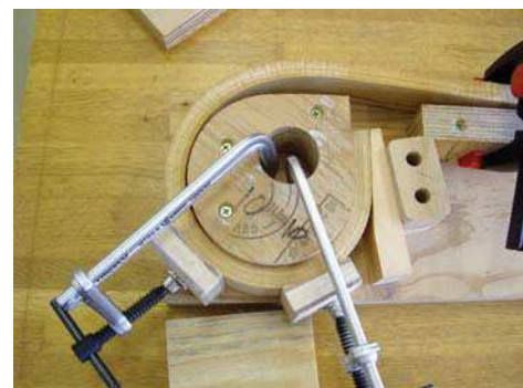
写真6 座部品の曲げ加工の様子と治具
