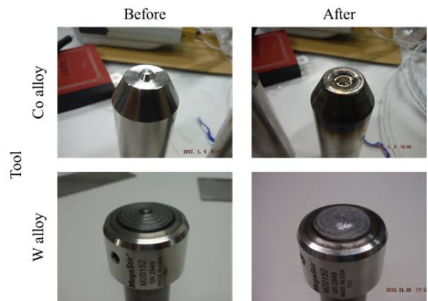
図2 接合実験前後の接合ツール先端部の外観写真
