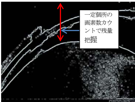
(c) ヒストグラムイコライズ+メディアンカット +ソーベル
