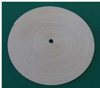
写真3 渦巻き状の水分センサ
