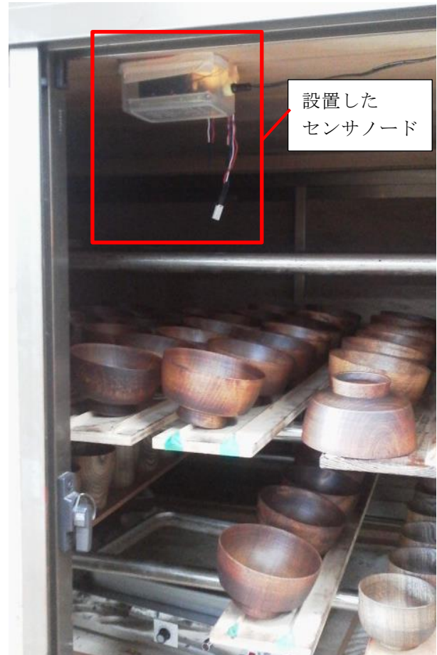
図 6 センサノードの設置状況
