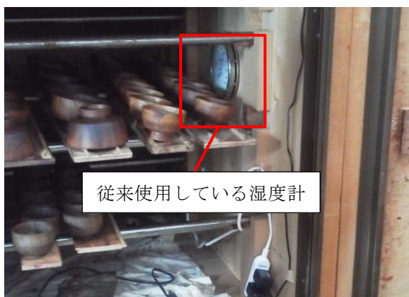
図2 漆風呂内に設置している湿度計
