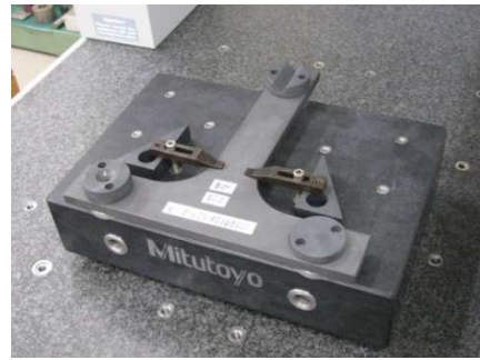
写真1 T型治具の固定方法
