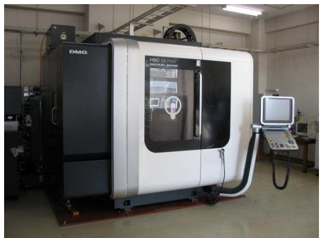
図1 導入した5軸マシニングセンタの外観
