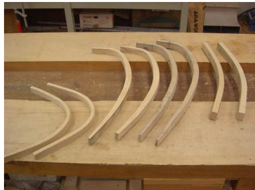
図8 加工工程 曲げ加工と乾燥を終えた部品
