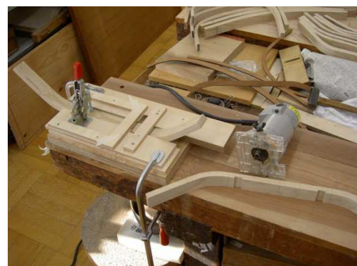
図9 加工工程 座板の溝加工用治具
