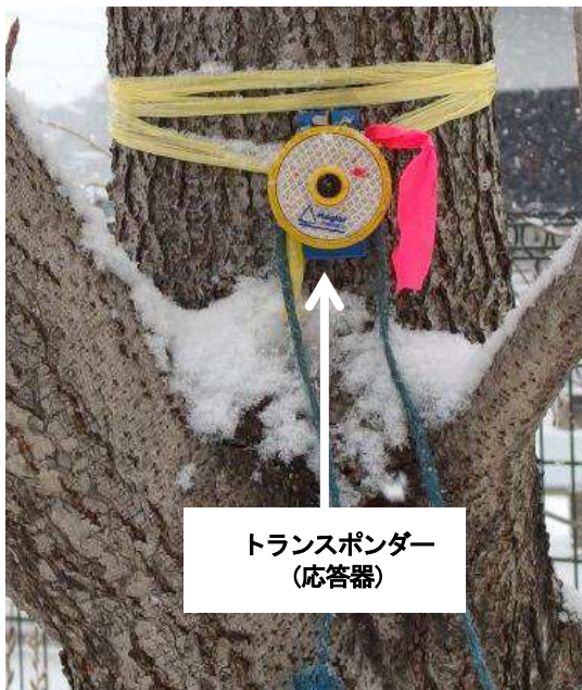
図2 トランスポンダー (应答器) の取り付け
