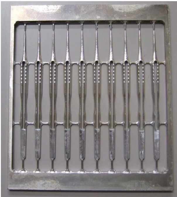
図10 加工サンプル（隙間7mm、10個取り）
