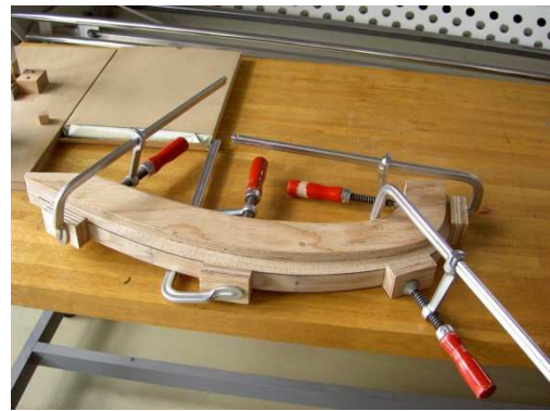
図7 加工工程 治具を用いた曲木加工
