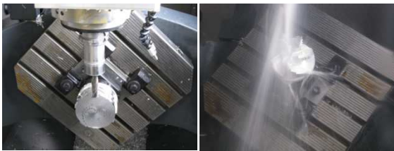
図8 4軸加工 (左：4軸荒取り、右：4軸面扱い)
