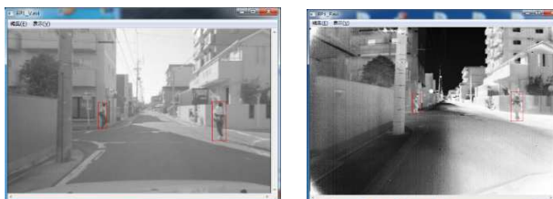
図7 可視光カメラの歩行者座標 (左図の赤枠) と遠赤外線カメラの歩行者座標 (右図の赤枠)
