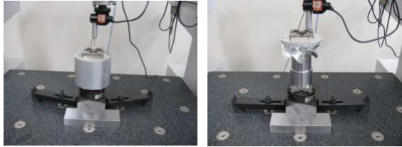
第1工程→第2工程 第2工程→第3工程 図6 CMMによるオフライン測定
