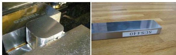
図3 加工材(左:CCM合金、右:SUS440)
