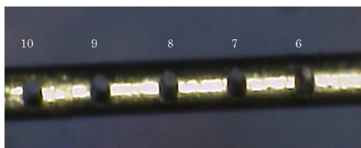
図3 電極長さ75mmで加工した鍼灸針形状写真
