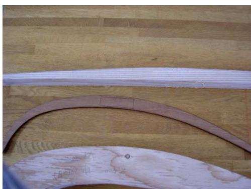
図6 加工工程 曲木材料の木取りと加工用定規
