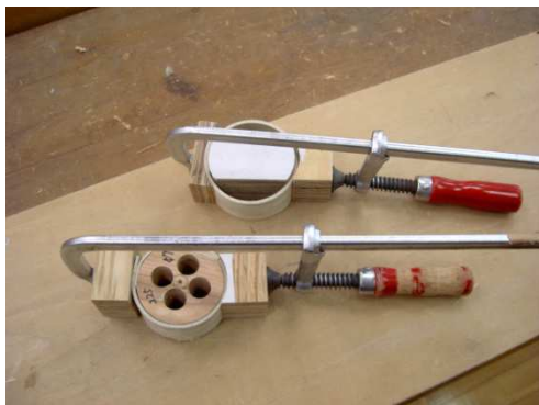
図12 加工工程 曲木加工
