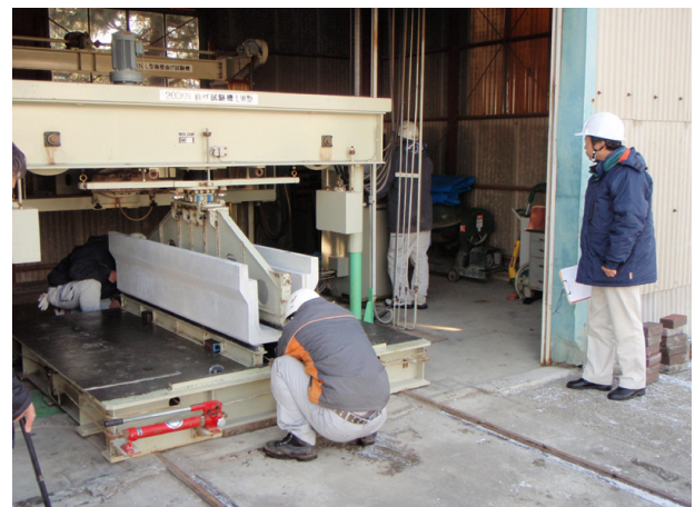
図10 U形側溝の製品曲げ強度試験
