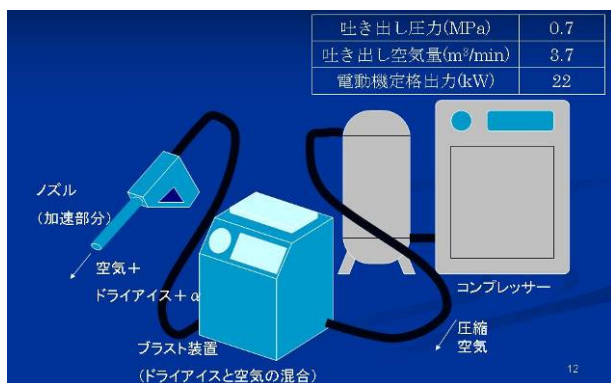
図1 ドライアイスブラスト装置概要
