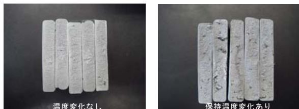
図4 Kモールド破断面
