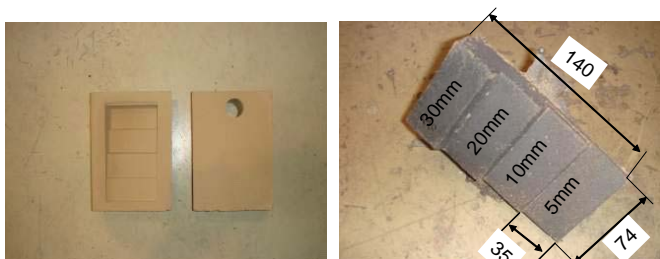
図1 階段状試験片鑄型と鑄造後の試験片
