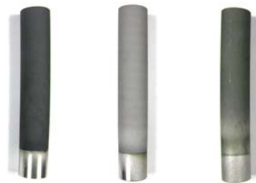
図 4 溶射試料の外観 (左からフレーム、HVOF、プラズマ)
