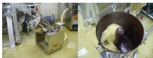
写真1 麺生地の蒸練工程
