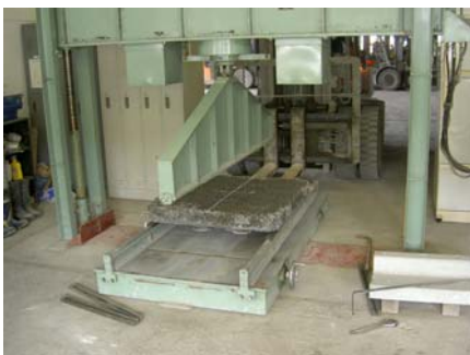
図11 曲げ強度試験状況
