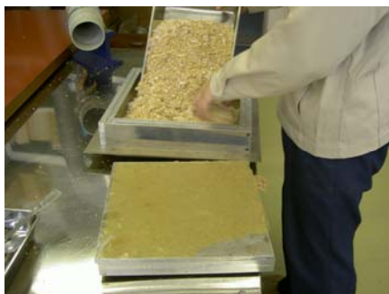
図3 型枠へのフォーミング作業
