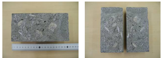
図5 供試体の破断面
