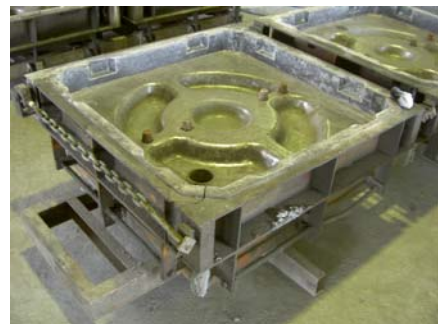
図6 ブロック金属製型枠
