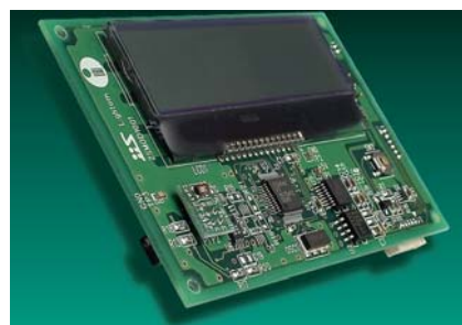
図 1 紫外線センサモジュールの外観図
