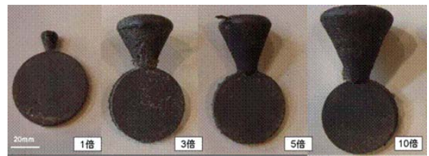
図2 鑄込み後の6mm厚試験片の外観
