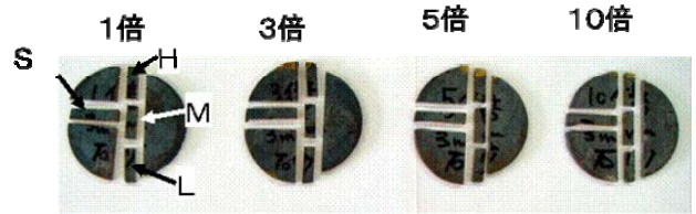
図3 切断した6mm厚試験片
