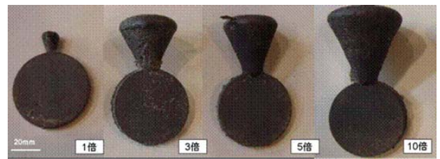
図2 鋳込み後の6mm厚試験片の外観
