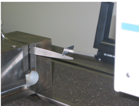
図2 刃先端粗さ測定
