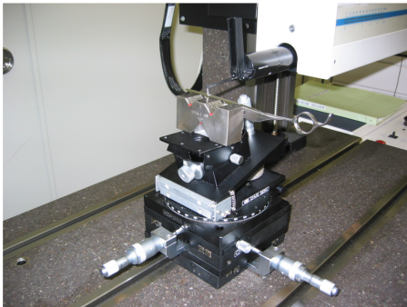
図1 刃先端 R 測定
