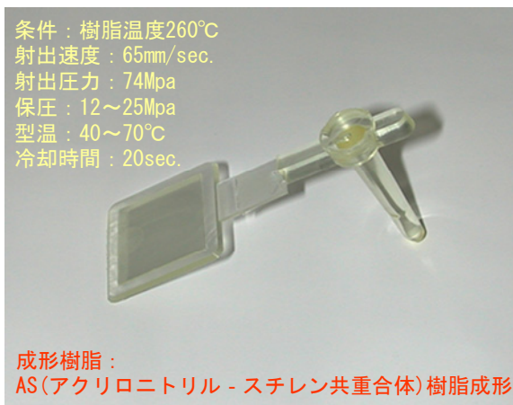
図10 プリズムシート転写電鍍金型の成形品
