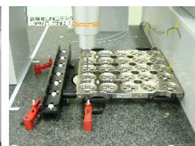
図12 ボールステップゲージによるスケール校正 (Y軸)
