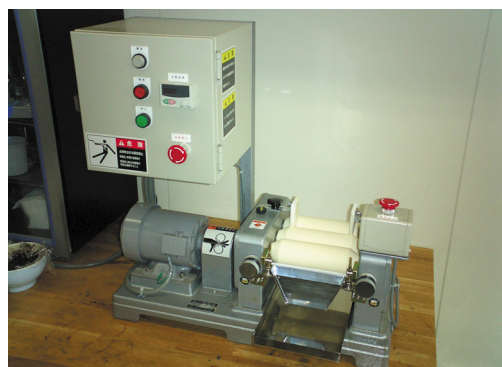
図1 均質化処理に使用したロールミル装置
