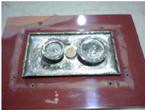
図12 ベークライト上に形成した電鍍
