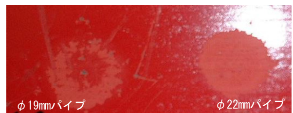
図4 粉体塗装の剥離(φ1.5mmペレット使用)
