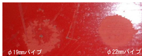
図4 粉体塗装の剥離(φ1.5mmペレット使用)
