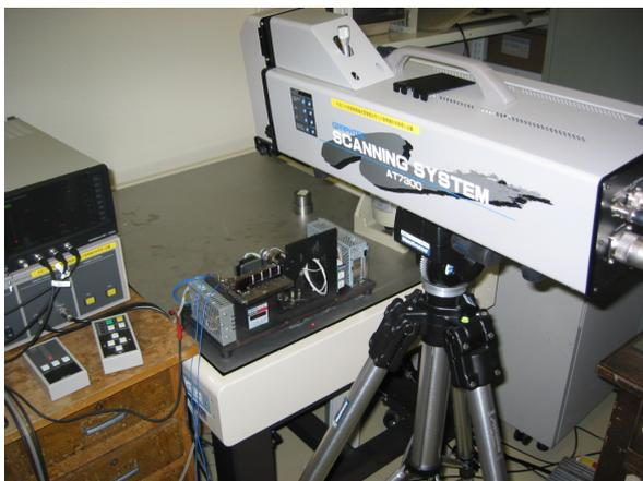
図2 振動測定機を併用した状態
