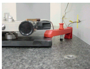
図9 クランプによる固定
