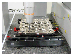
図11 ボールステップゲージによるスケール校正 (X軸)
