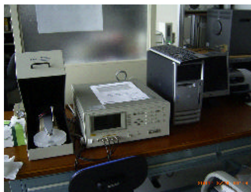
図6 水銀プローブ式キャリア密度測定装置
