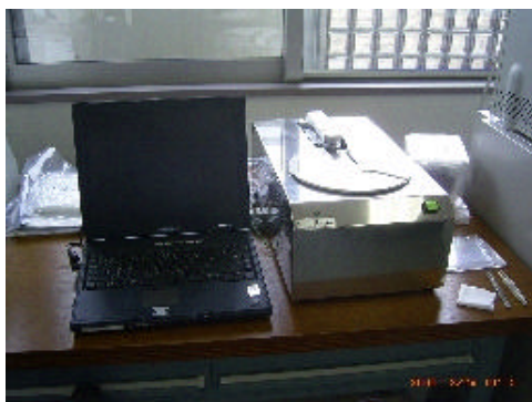
図7 非接触シート抵抗測定装置
