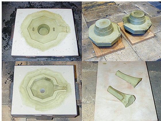
左上：上型、左下：下型、右上：中子、右下：上型 図5 完成した鋳型
