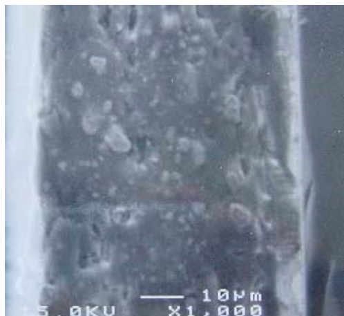
ガラス基板 | \text{Cu}_2\text{Se}/\text{In}_2\text{Se}_3 | \text{In}_2\text{Se}_3/\text{Cu}_2\text{Se} | ガラス基板
