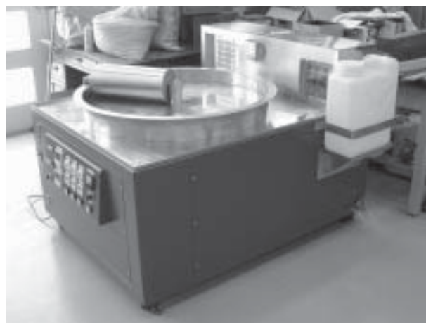
図2 試作した速乾性漆液加工装置
