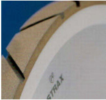
図1 平面研削用スリット溝入ホイール
