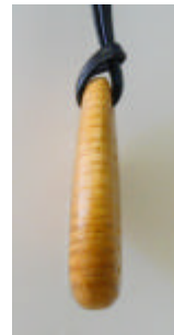
写真6 端面成形加工と側面形状 （角がかけないような成形面）
