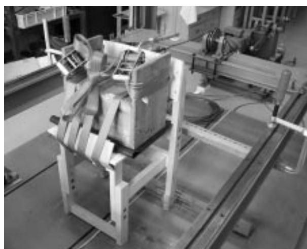
写真5 いすの繰り返し耐衝撃性試験
