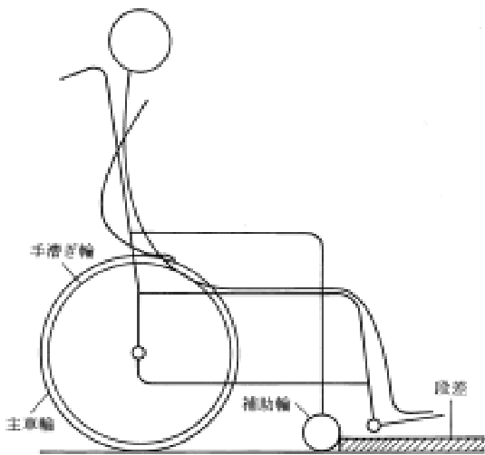
図1 段差に直面した車椅子の状態
