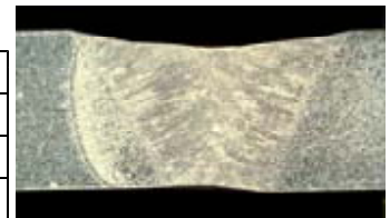
図14 TIG溶接条件と断面マクロ組織
