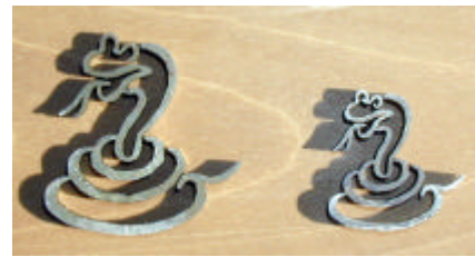
写真5 蛇（金型） （右：目を入れた金型微細加工）
