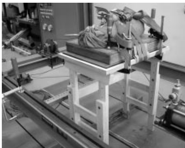
写真3 機の繰り返し耐衝撃性試験
