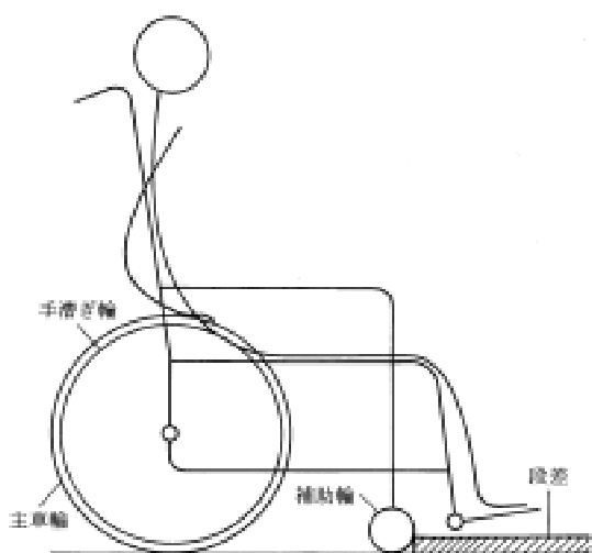
図1 段差に直面した車椅子の状態
