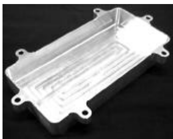
図4 インパルスハンマーによる減衰比測定用供試体
