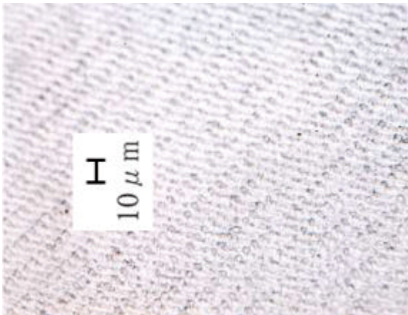
b) s=500\text{rpm}, f=2.5\text{mm}/\text{min} (=5 \mu\text{m}/\text{rev})
