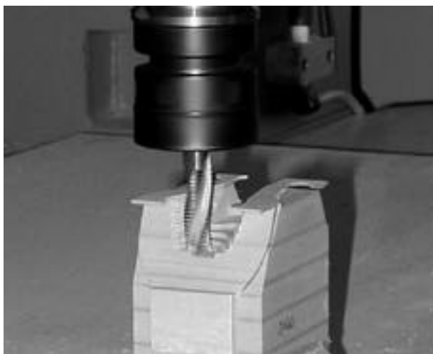
写真3 ジグを使った内側荒加工状況
