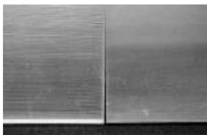
図9 分割製作による面の段差の違い（右が分割）
