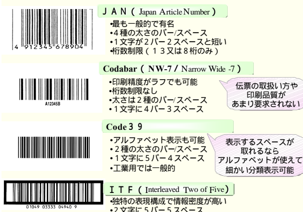
図3 代表的なバーコードの種類と特徴
