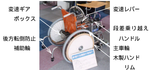
図3 試作した新機能付加車椅子の外観
