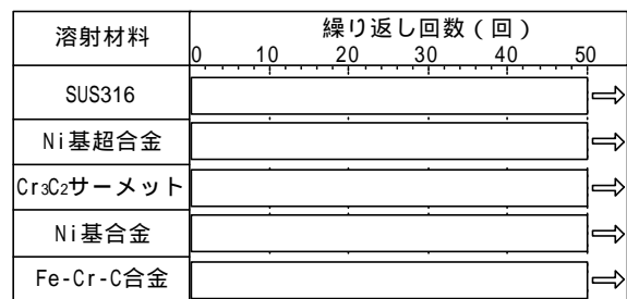
図 13 溶射材の熱疲労試験結果
