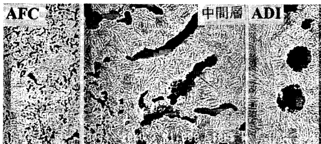
図4 オーステンパ処理後の界面の顕微鏡組織 (ペーナイト化573K×1hr、SEM像)
