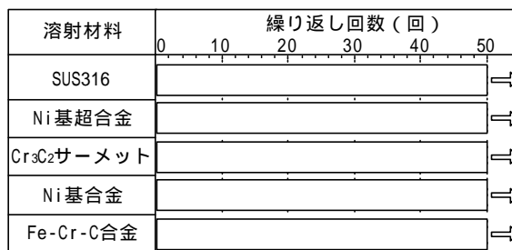
図 13 溶射材の熱疲労試験結果
