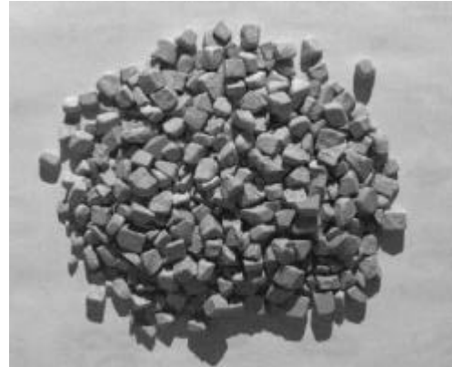
図1 試作した人工骨材
