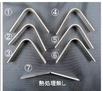
レーザー熱処理条件と曲げ試験結果
