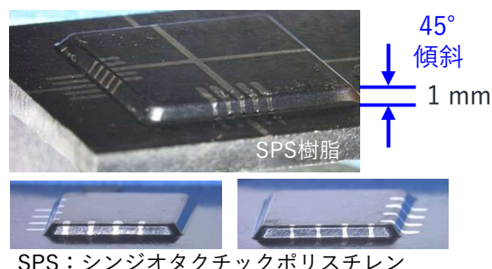
図3 90°段差(左)および45°斜面(右)を持つ樹脂基板へのパターン形成
