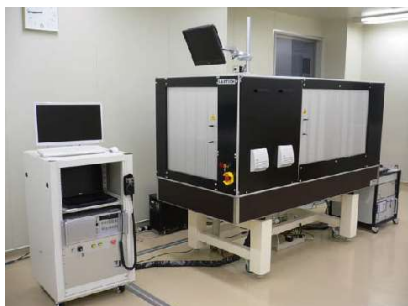
図1 超短パルスレーザー微細加工機
