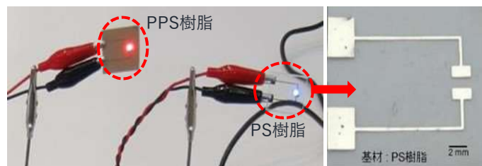
図2 透明ループアンテナ(左)およびLED実装回路パターン試作(右)
