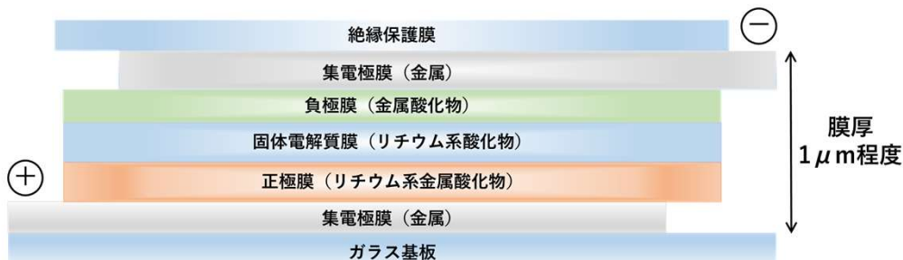
図1 薄膜型全固体電池の構造図
