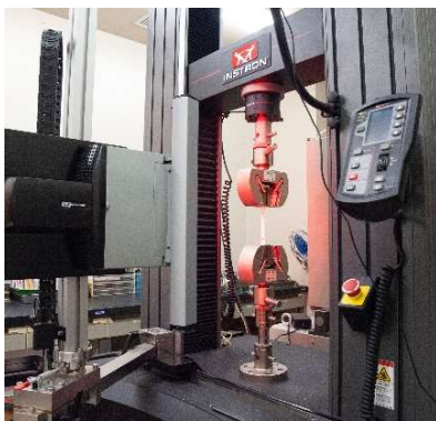
Instron 5982型による試験の様子
