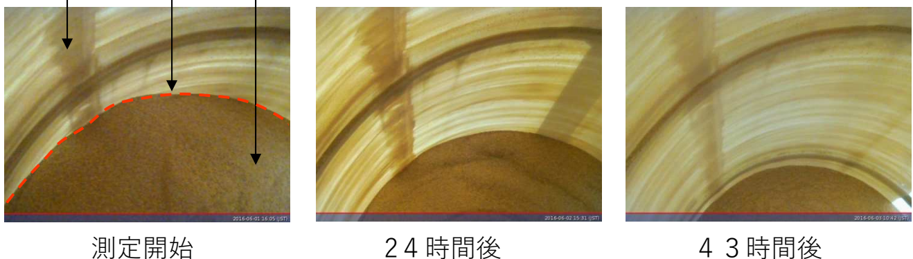
図2 タンク壁面と飼料との境界線で残量把握が可能
