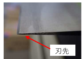
肉盛り材の刃物加工工程
