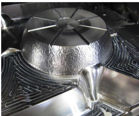
図3 NC加工したマッチプレート
