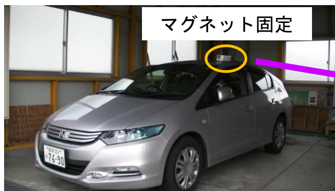
図3 実車のFIR-Vカメラ設置はマグネット固定
